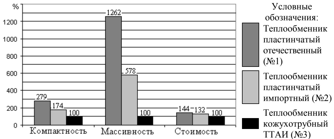
Рис. 19 Сопоставление теплообменников по показателям компактности, массивности и стоимости
